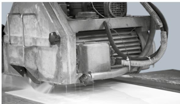
16 | Kerlite kann mit Diamantscheiben geschnitten werden. Die Scheiben müssen für Feinsteinzeug geeignet sein und sich in gutem Zustand befinden. Es wird empfohlen, mit hoher Drehzahl (> 2.000 U/Min) und einer Vorschubgeschwindigkeit zwischen 0,5 und 1 m/Min. zu arbeiten. Je nach Scheibentyp und Schnittlänge kann die Wasserkühlung der Trennscheibe notwendig sein. Außerdem sollte die Drehzahl beim Eintreten des Werkzeugs in die Platte und beim Austreten aus der Platte reduziert werden.
