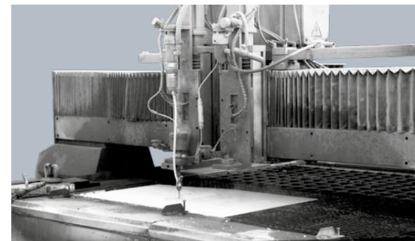
18 | Kerlite kann mit Wasserstrahlmaschinen geschnitten werden. Wir empfehlen eine Arbeitsgeschwindigkeit zwischen 2 und 3 m/Min.
