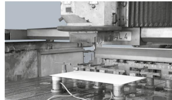
17 | Kerlite kann mit CNC-Maschinen geschnitten werden. Bei diesen Maschinen muss der Fräser mit einer Drehzahl zwischen 12.000 und 18.000 U/Min. und einer Vorschubgeschwindigkeit zwischen 0,5 und 1 m/min. arbeiten.
